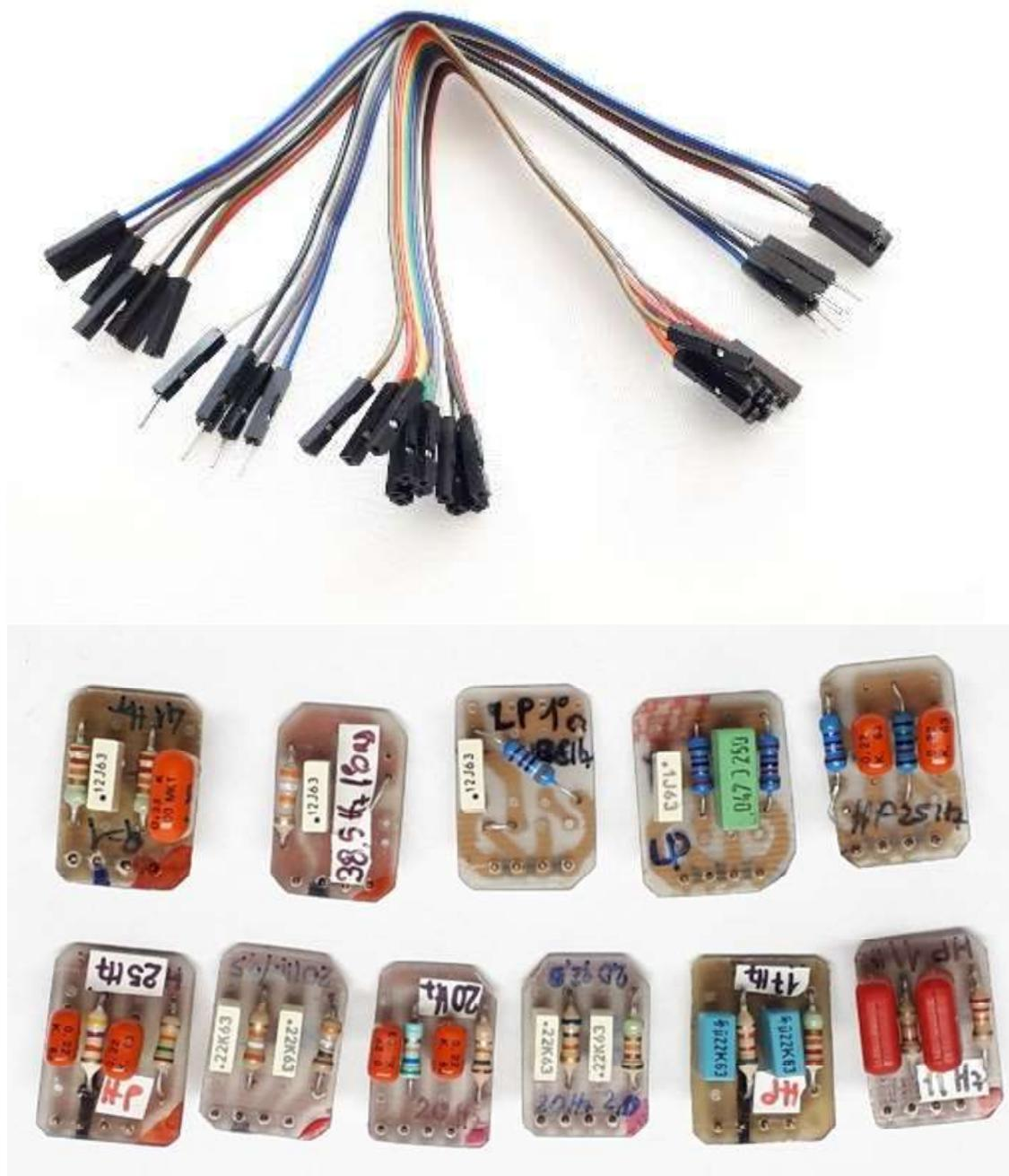
Fig. 4 – Flat cable Maschio-Maschio, Femmina-Femmina e Maschio-Femmina, per tutte le esigenze, e prototipi delle schede Piggyback per le celle di filtro programmabili
