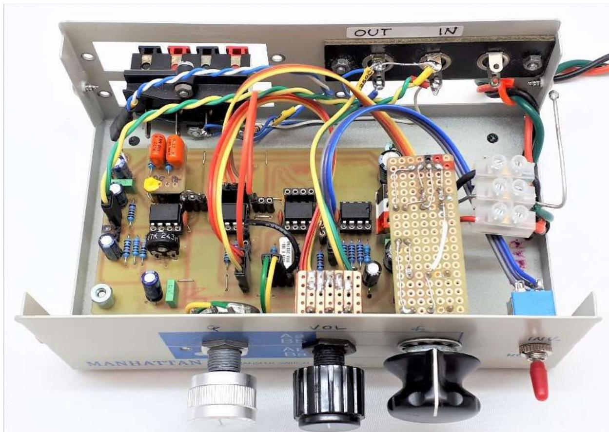
Fig. 3 – Prototipo della *Motherboard* per il filtro del subwoofer con un *Piggyback* e connettori montati. Si noti al centro, sopra il terzo *Ic* (da sx) lo spazio per l'eventuale montaggio fisso dei componenti di un modulo di filtro.
