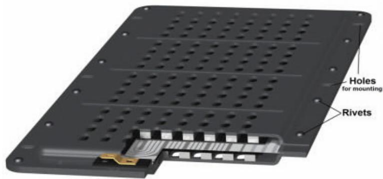
**FIG.2 NEO-10: sezione.**
