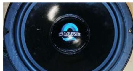
In effetti, su altoparlanti larga banda, oppure su woofer di pessima qualità, la cupoletta potrebbe introdurre differenze visibili; ma sono legate al diametro di incollaggio, non alla cupola stessa. Certe membrane sono così inconsistenti che quel giro di colla, in quella zona, produce un irrigidimento del cono che può risultare significativo. Se accade, quel woofer non è degno dell'appellativo "Hi-Fi".
