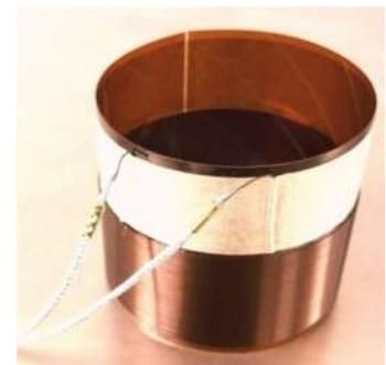
Attorno a questi supporti si avvolge il filo di rame, che può formare **due o quattro** strati, se stiamo realizzando un woofer, ma sempre **soltanto due** se si tratta di un tweeter. Gli strati di rame devono essere sempre in numero pari, perché i terminali di collegamento devono uscire dalla stessa parte.
