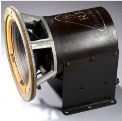
Se vi ricordate, l'abbiamo già visto all'inizio sull'altoparlante del 1925 di Rice e Kellogg, che vi ripropongo; non solo c'era già una membrana di forma conica, ma era fatta dello stesso materiale che continua ad essere il più usato, fino ai giorni nostri.
