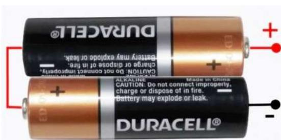
Facile no?... Se la tensione raddoppia, in pari misura aumenta anche la corrente; visto che il  $BL$  è sempre quello, ci dobbiamo aspettare che anche i newton passino da 2 a 4.
